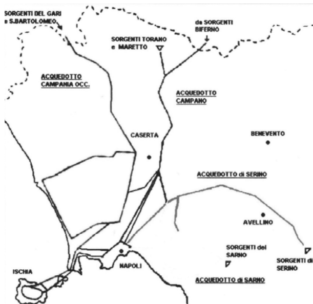
Fig. 3 - Principali schemi acquedottistici a servizio della città di Napoli
